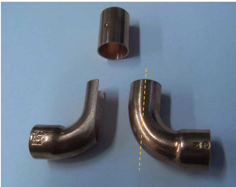
Das Hosenrohr entstand aus zwei 12er Kupferbögen aus dem Wasser- bzw. Heizungsbau und einer Verbindungsmuffe. Die beiden Bögen werden – wie auf dem Bild zu sehen - an einer Seite halbiert und bearbeitet bis sie in die Muffe passen. Die 12er Rohre haben einen Innendurchmesser von 10mm. *Wem dies nicht genügt kann auch 15er Rohrbögen verwenden. Die nachfolgenden Durchmesser und Gewinde sind dann entsprechend anzupassen. Evtl. muß die Durchführung in der Rauchkammer vergrößert werden.*
