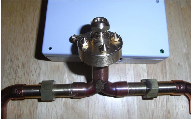
So sieht das Ganze jetzt aus. Hier mit Dampfduüse die aus Messing Sechskant SW14 15mm lang hergestellt wurde. Außen Gewinde M10x1 10 lang und Innen vorerst Bohrung 5mm von oben und unten leicht konisch. Der tatsächlich benötigte Durchmesser muss unter Dampf durch Versuch herausgefunden werden.
