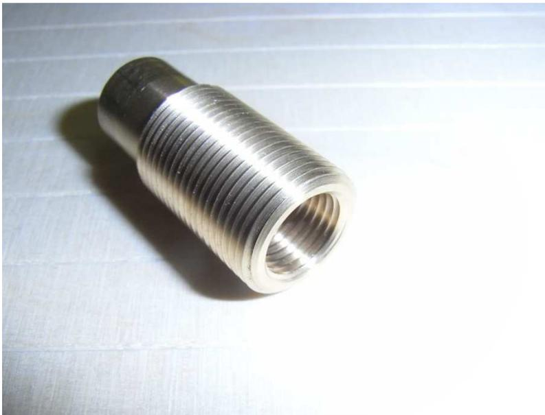
Nach oben geht es über eine eingelötete, 30mm lange Hülse aus Messing die am unteren Ende in die Muffe passt (11,8 – 12mm) und ein Aussengewinde von M14x1 o.ä. bekommt. Innen wird von unten 10mm tief auf 10mm aufgebohrt und der Rest erhält ein M10x1 Gewinde. Das Innengewinde ist für die Dampfdüse und das Aussengewinde für den Hilfsbläser. So können beide unabhängig voneinander in der Höhe verstellt werden.
