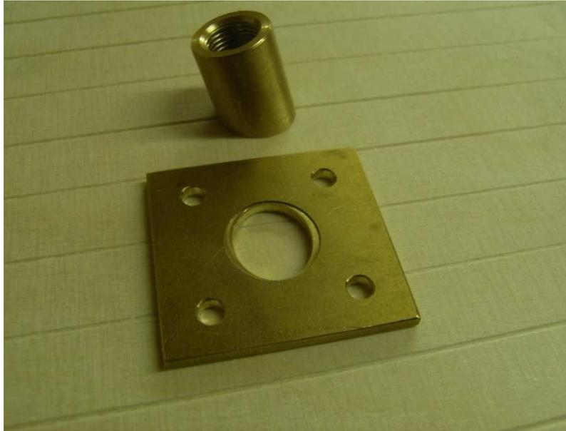
Der Anschluss am Zylinderblock ist etwas kniffliger da die Dampfzuleitung unter einem Winkel von ca. 16 Grad aus der Rauchkammer und dem Zylinder kommt. Hier wurde zunächst eine Grundplatte aus 2er Messing mit einem ovalen Durchbruch und ebensolchem Absatz hergestellt.
