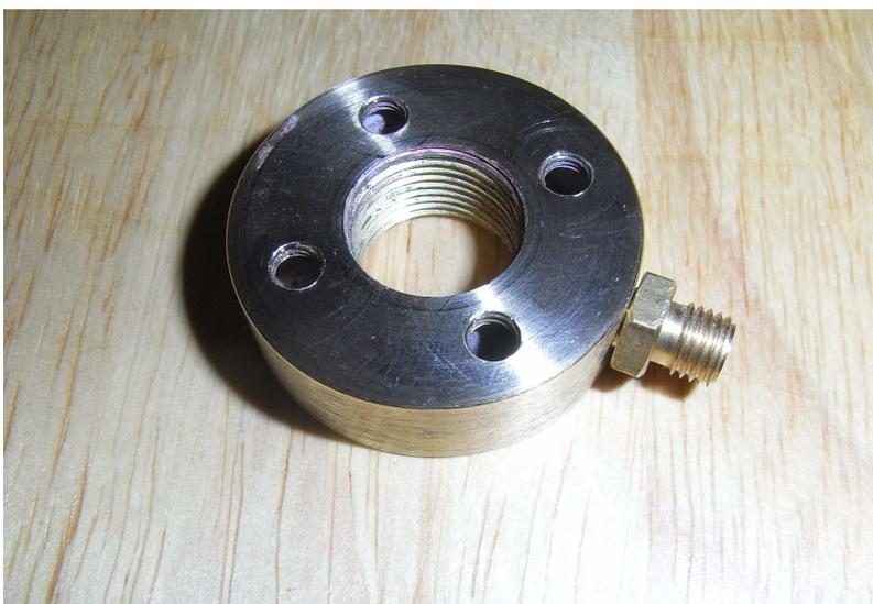
Nachdem alle Späne draußen waren wurde hartgelötet und der ganze Verteilerring auf  $12\text{mm}$  abgedreht.
