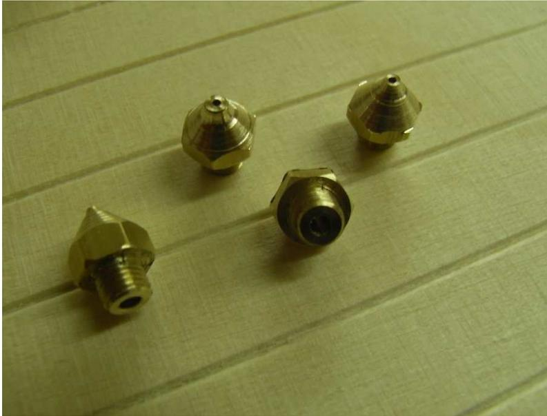
In die Löcher mit den M4x0,5 Gewinde kommen nun die Düsen. Diese sind somit auswechselbar und können den Verhältnissen angepasst werden. Die Düsen bestehen aus Sechskant-Messing SW6mm. An der einen Seite das M4x0,5 Außengewinde 3mm tief und 2mm Bohrung 4mm tief. Anschließend mit einem Bohrer D=0,6mm – 1mm mit einer Gesamttiefe von 10mm bohren und bei 8mm abstechen.
