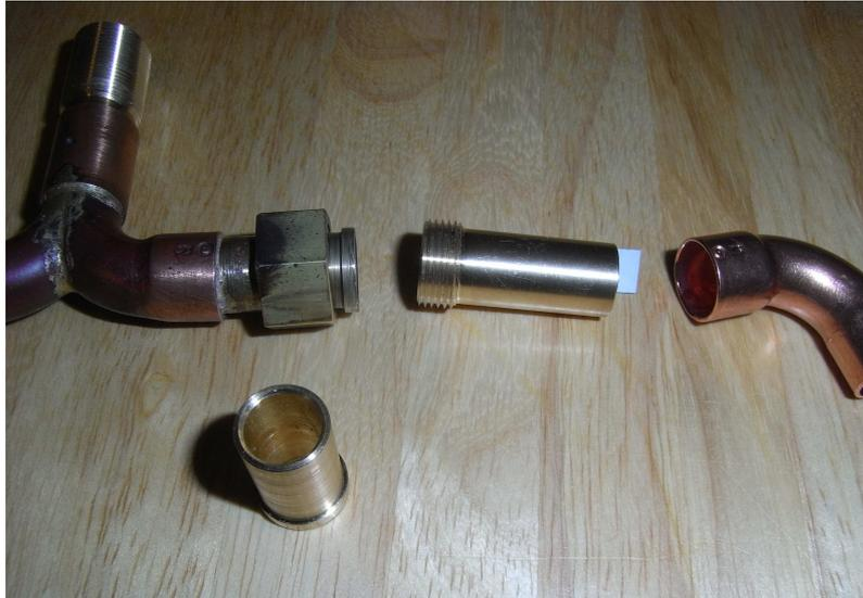
Richtung Zylinder werden zwei 24mm lange Messinghülsen  $D=12\text{mm}$  mit Bund  $D=13\text{mm}$  2mm hoch hart verlötet. Vor dem verlöten ist jeweils eine Mutter mit Ansatz M14x1 aus Sechskantmessing SW16 – SW17 aufzuschieben. Der Ansatz der Mutter drückt den Bund der Hülse auf den Dichtring.
