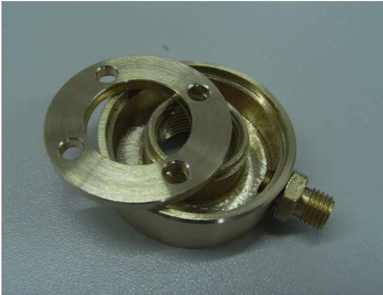
Die Einzelteile des Verteilerringes.
