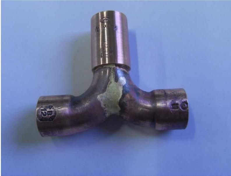
Das ganze wird anschließend hart verlötet. Damit sich die Lötstelle bei weiteren nachfolgenden Lötprozessen nicht wieder lösen kann geschieht dies mit einem Lot mit höherer Schmelztemperatur.
